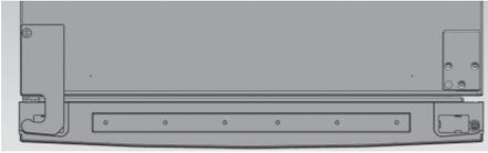
Finalement, vérifiez le bon alignement des portes et leur fermeture hermétique. Si nécessaire, ajustez les pieds ajustables de l'avant afin d'obtenir un positionnement bien horizontal de l'appareil.
