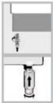
Αν χρειάζεται να οριζοντιώσετε τη συσκευή, βιδώστε τα ρυθμιζόμενα πόδια στήριξης στις παρεχόμενες θέσεις σε κάθε γωνία της βάσης της συσκευής μαγειρέματος (βλ. εικόνα).
