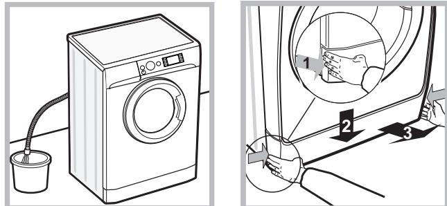
2. Zkontrolujte, zda je hladina vody uvnitř zařízení nižší, než je úroveň otevření dveří; v opačném případě vypusťte přebytečnou vodu vypouštěcí hadicí a zachytěte ji do vědra, jak je znázorněno na obrázku.
