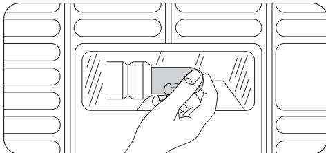
2. Vervang het kapotte lampje door een nieuw lampje met hetzelfde vermogen dat specifiek bedoeld is voor huishoudelijke apparaten (het maximale vermogen wordt weergegeven op de lamp zelf).
