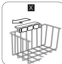
Hängen Sie die Körbe auf die Oberkante des Gefriergeräts (X) oder in das Innere des Geräts.
